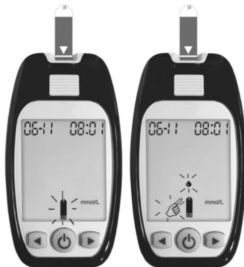
2. Führen Sie einen Teststreifen in Pfeilrichtung in das Messgerät ein. Das Messgerät schaltet sich automatisch ein und ein Teststreifensymbol wird angezeigt.
