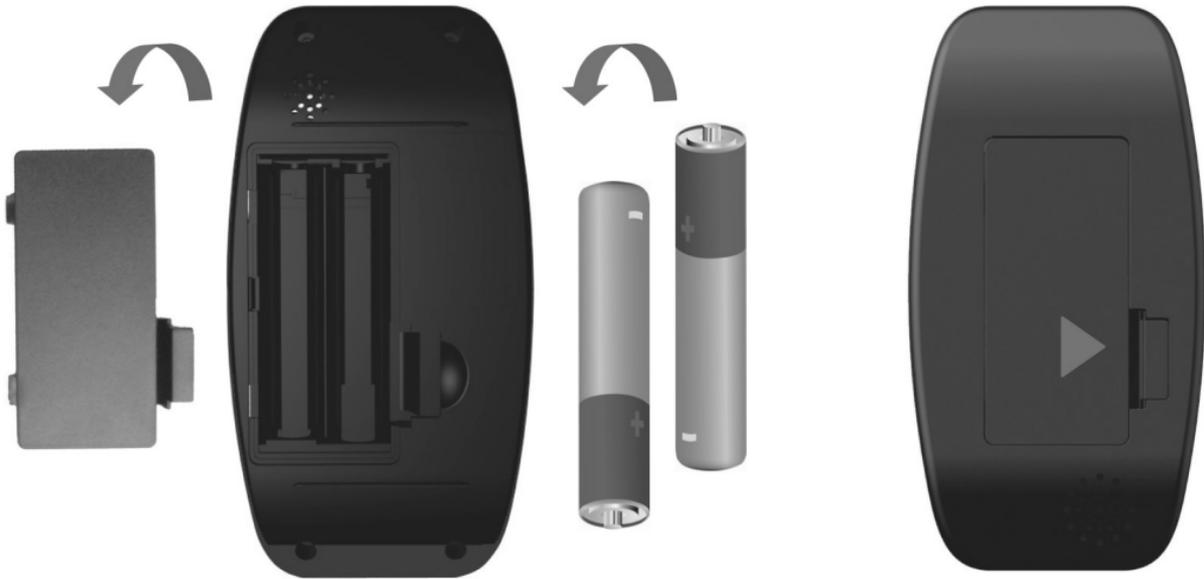
1. Öffnen Sie den Batteriefachdeckel auf der Rückseite des Messgerätes, indem Sie den Deckel in Pfeilrichtung schieben und nach oben drücken.
