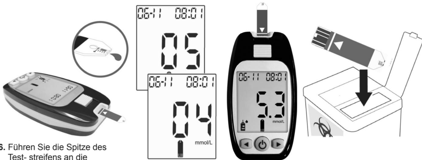
6. Führen Sie die Spitze des Test- streifens an die Kontrolllösung. Durch die Kapillarwirkung des Teststreifens füllt sich die Reaktionszone automatisch.
