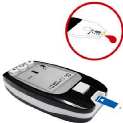
6. Führen Sie die Spitze des **Teststreifens** an die Kontrolllösung. Durch die Kapillarwirkung des Teststreifens füllt sich die Reaktionszone automatisch.
