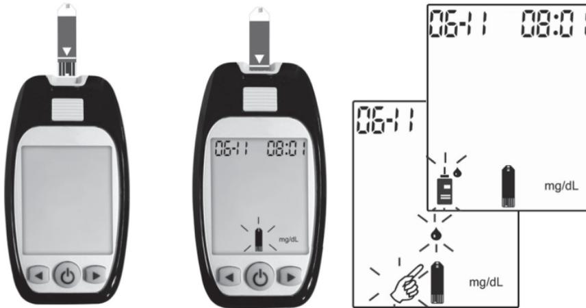
1. Führen Sie den Teststreifen in Pfeilrichtung in das Messgerät.
