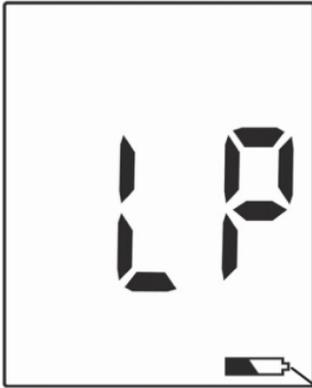
Das Messgerät wird mit 2 x 1,5V (AAA) Batterien betrieben. Die Batterien reichen normalerweise für mehr als 2000 Tests. Legen Sie die Batterien ein, wenn Sie das Messgerät zum ersten Mal verwenden oder ersetzen Sie sie durch neue Batterien, wenn das „LP“ Symbol auf Ihrer Anzeige erscheint.
